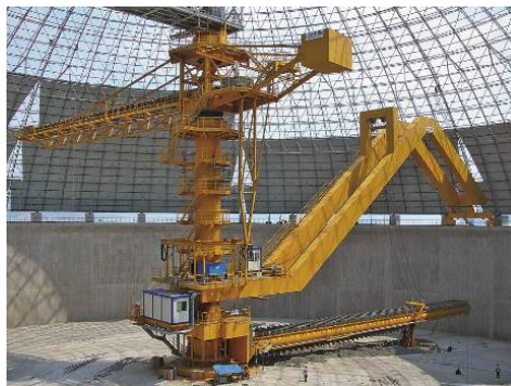
SCHADE-Portalkrater und SCHADE Kreislager (Fotos SCHADE)
