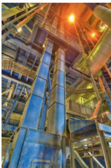
Foto 2: Beispiel für ein AUMUND-Kettenbecherwerk Typ BZW (Foto AUMUND)
