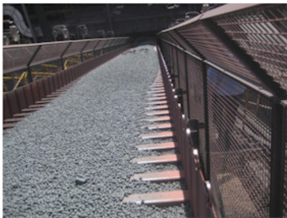
Beispiel für einen AUMUND-Pellet Förderer Typ KZB (Foto AUMUND)
