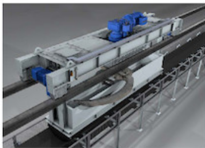
AUMUND-Bunkerentleerungswagen BEW Typ LOUISE in Blockbauweise mit zwei Räumarmen (Illustration: AUMUND)
