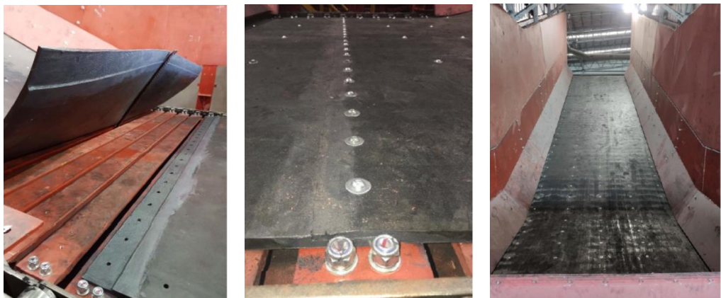
Der Gurt wird mit den Querriegeln verbunden.
